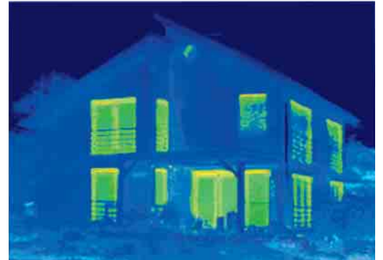
Na de zorgvuldige plaatsing van nieuwe ramen van het Schüco LivIng-systeem bewijst de thermografie dat de energie-investering zich goed loont. Het oorspronkelijke energieverlies is nagenoeg volledig weggewerkt.
